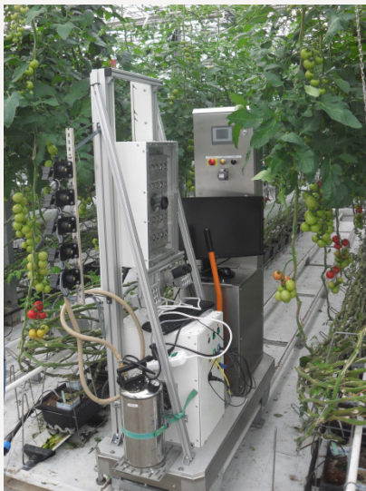
Side Crop Viewer met Chlorofyl fluorescentie sensor en spuit
